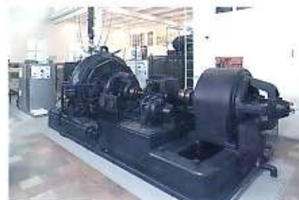
De zender van SAQ, geen elektronica maar werktuigbouwkunde. Vermogen: 200 kW; frequentie : 17,2 kHz; toerental: 2115 1/m; omloopsnelheid rotor: 638 km/h (!); aantal polen: 976.
